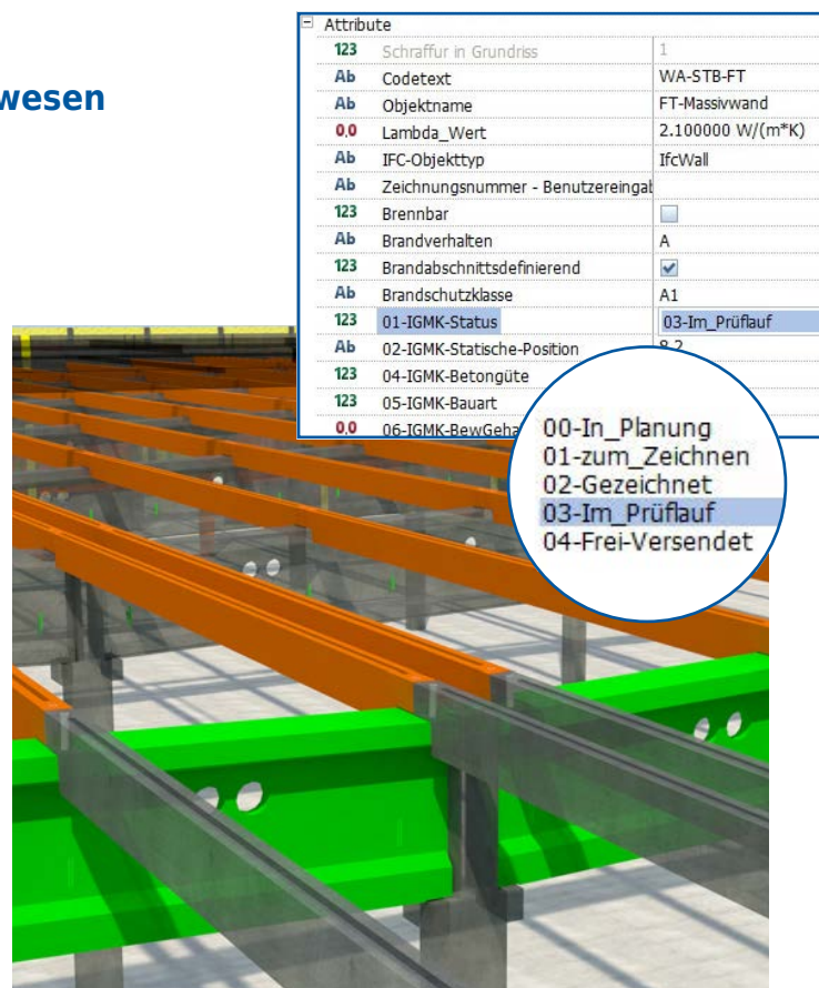
Bild 1 3D-Visualisierung mit Attributen (BIM)
